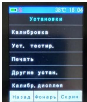
Пункт **Калибровка** предназначен для сервисных инженеров, для входа требуется ПИН-код.
