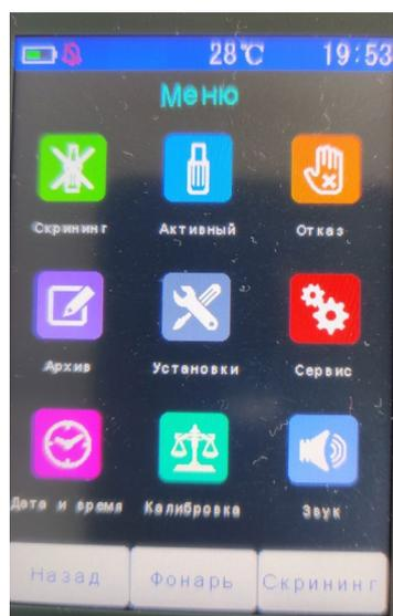
В верхней части дисплея располагаются пиктограммы состояния аккумулятора и звуковых сигналов, значение температуры в рабочей зоне сенсорного датчика и текущее время.
